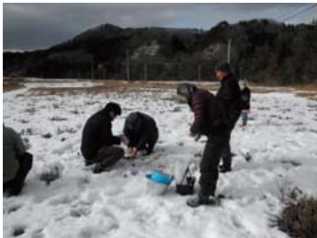
雪の中で水田の土壌採取(円筒形の試料を採取して1cmごとの放射能を測定する)
