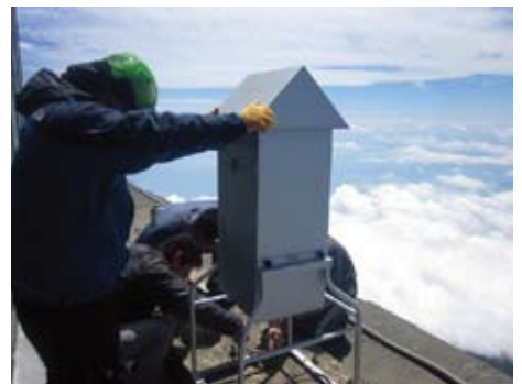
山頂でエアロゾルを採取しているハイボリュウムエアサンプラーの設置と試料採取(測候所裏)
