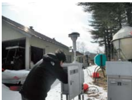
エアロゾル採取装置のフィルター交換 (飯館村佐須滑)
