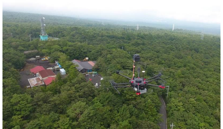
写真2 ドローン試験飛行による鉛直観測
