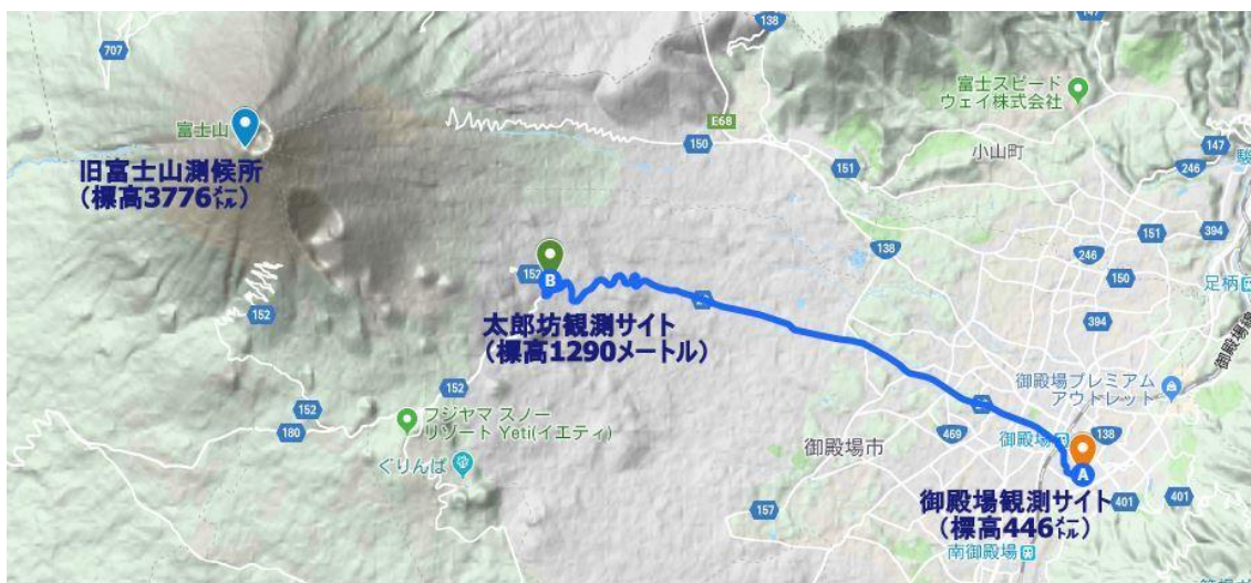
富士山頂から山麓に至る 3 箇所の観測拠点はそれぞれ標高が異なるため、大気鉛直分布の計測などが可能となる
