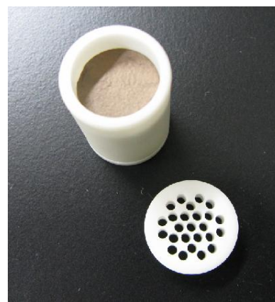
Fig 2 パッシブサンプラーの構造、ろ紙と拡散プレート
