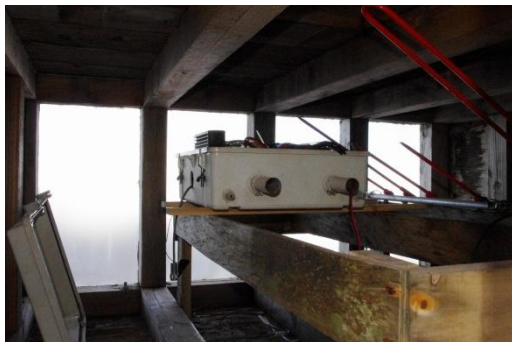
(a) ハット内に設置した、47GHz・24GHz 送信システム
