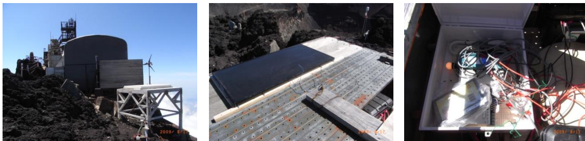
図2 クリーンマイクログリッド試験 (太陽光パネル1枚、風力発電機1機、鉛蓄電池2個)
