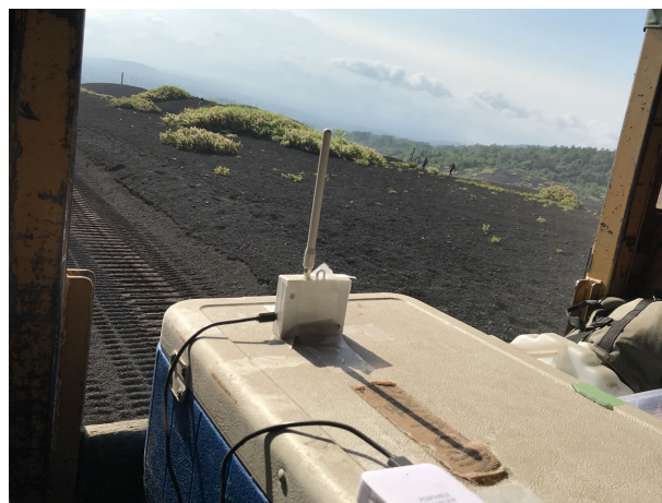
図2 ブルドーザ移動中の通信実験の様子
