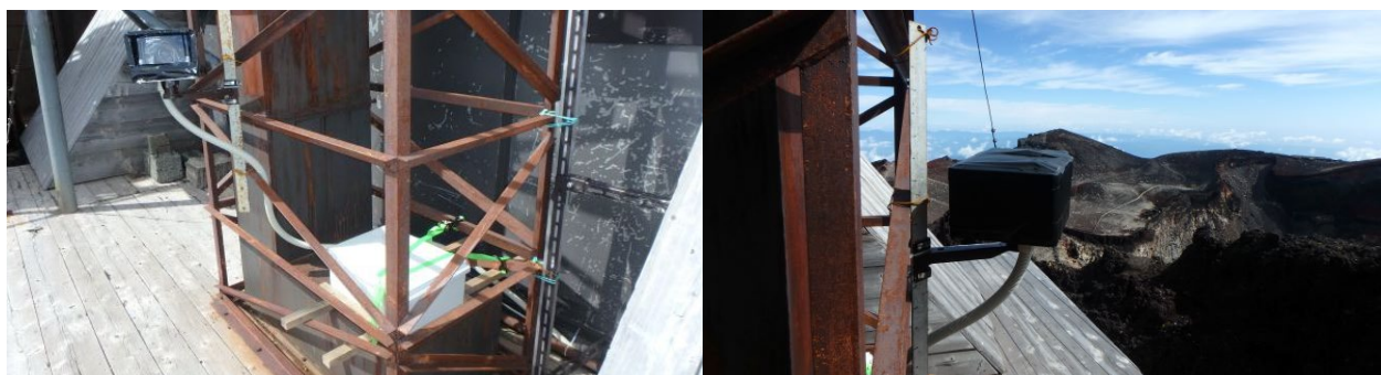
図1 アルファセブンによる自動観測システム。左は前景、右は後景(正面は白山岳)
