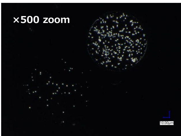
図4 ドローン採取された雲滴による硫酸バリウム結晶生成
