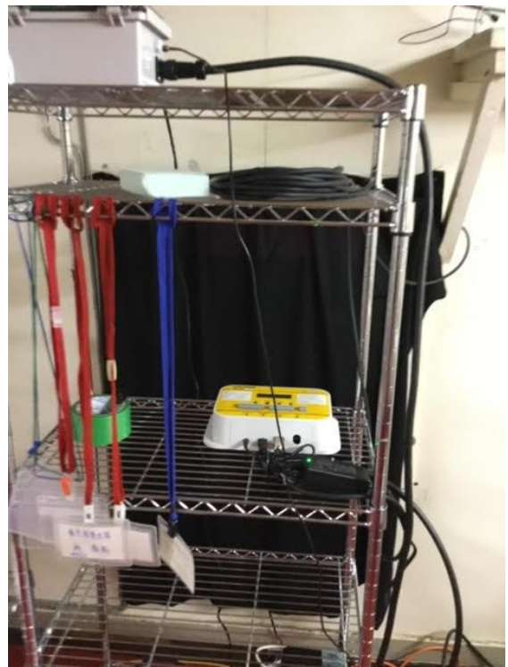
図1 大気電場測定機器 (a) 1号庁舎屋根に設置したセンサー部分 (b) 屋内に設置したデータロガー部分
