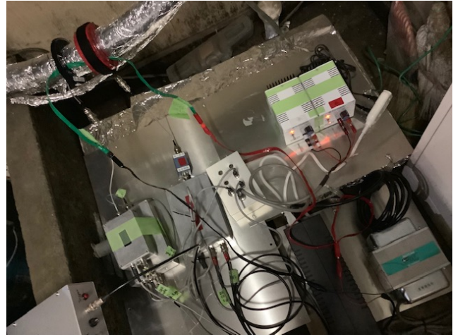
図1 ログスキーコイルを用いた測定。
