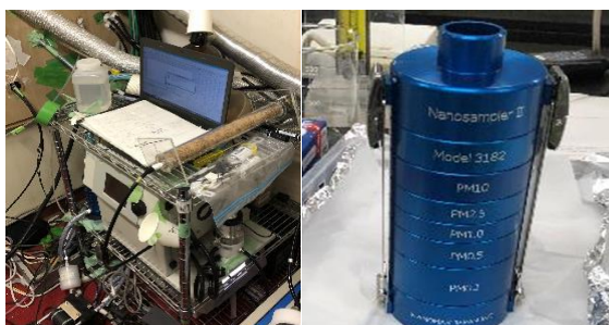
図1 観測機器 (左: Nano-SMPS, 右: ナノサンプラー)
