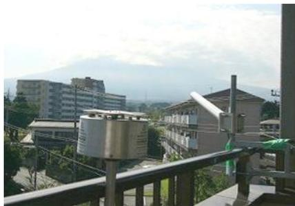
写真 御殿場基地事務所のベランダに取り付けられた電場計(左)と山頂向け無線LANのハ木アンテナ(右)
