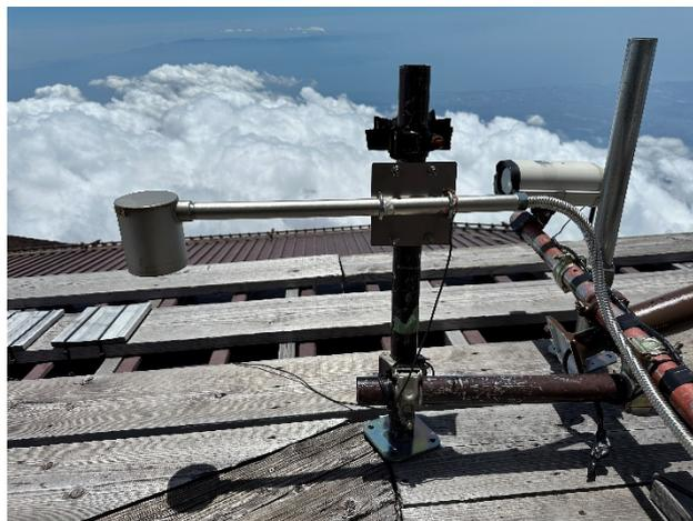
図 1 フィールドミルの設置状況
