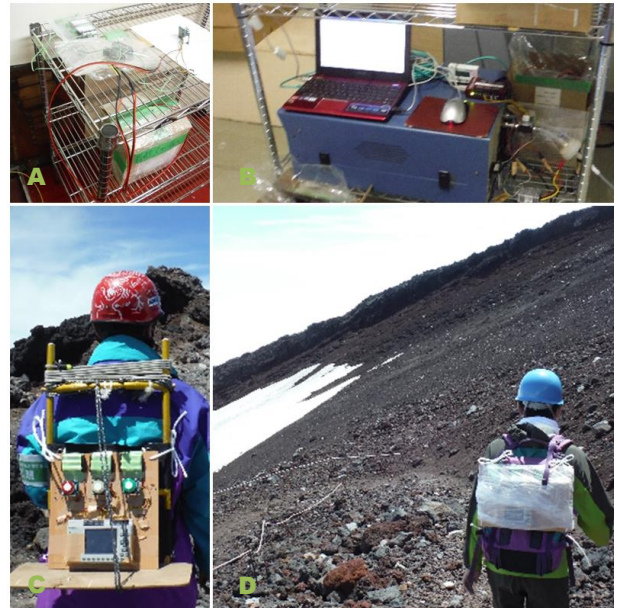
A 越冬テスト中のSO 2 測定システム B 山頂での精密測定装置とガスセンサーの比較測定 C 電池駆動でのガスセンサーシステムの野外テスト D ガスセンサーシステムをリュックに取り付け測定をしながら下山
