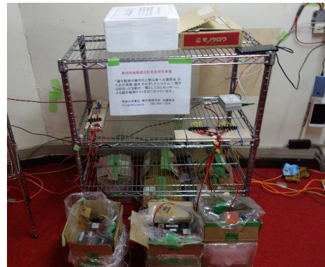
富士山頂で越冬テスト中のSO 2 測定システム
