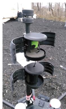
図1 ドローンに搭載した気象測器とオゾン計
