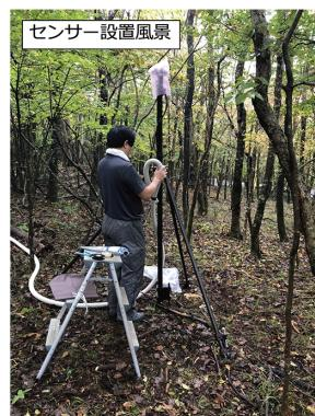
図2 太郎坊に設置した地磁気センサー
