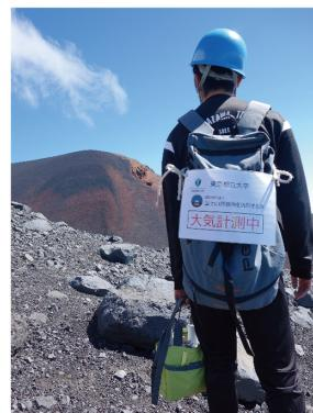
図3: 宝永火口付近を携帯型火山性ガス測定システムを手に持ち歩いて観測中
