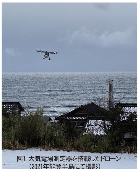
図1. 大気電場測定器を搭載したドローン
