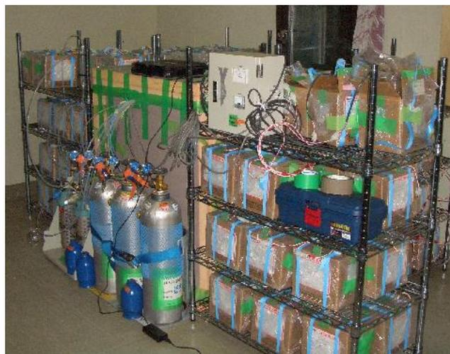
写真1. 断熱処理を施された装置とシステム、100 個のシール型鉛蓄電池
