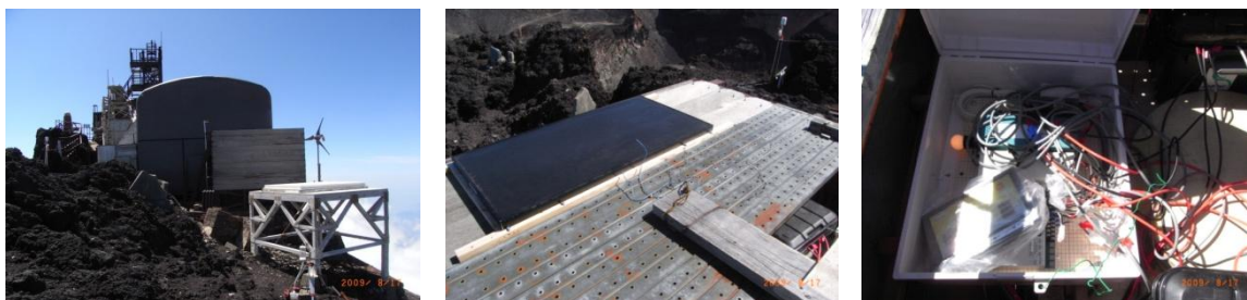
図2 クリーンマイクログリッド試験 (太陽光パネル1枚、風力発電機1機、鉛蓄電池2個)
