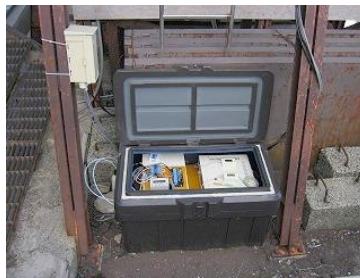
写真1 (左) 貯水槽への太陽光パネルの取り付け作業 (右上) 太陽光パネル (右下) データロガー等
