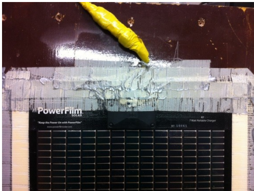
図 5.屋外設置で劣化した太陽光パネル 図 6.太陽光パネルの設置状況
