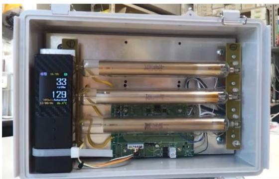
図5 展示用同時計数回路 T-Mu2-3GM (TAC 社) 心臓部のプリント基板は T-Mu1 と同一。図4の T-Mu1 のプリント基板上に GM 管 SBM-20 を3本実装できる。ただし、計数率が下がる。
