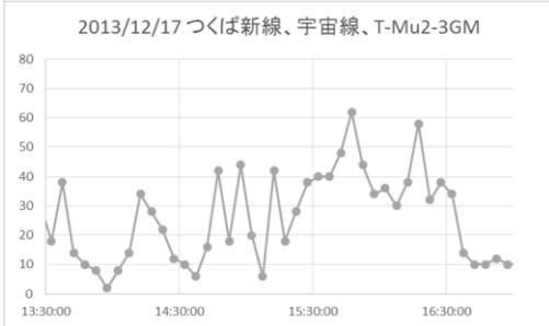
図 12 新秋葉原駅からつくば駅までの列車内外の 2 次宇宙線の計数率、片道、下り、TC=5 分測定器 T-Mu2-3GM、(単位 cp10m = count/10min)
