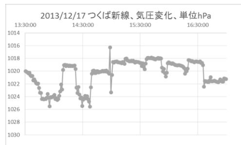
図 15 新秋葉原駅～つくば駅、つくば新線下りの高度変を気圧であらわす。(気圧:単位[hPa]) T-Sp02 縦軸は気圧、ただし目盛は上下を逆転しているため、標高に即対応する。新秋葉原駅、つくば駅が地下駅であることおよびその地下深度がほぼ推定できる。
