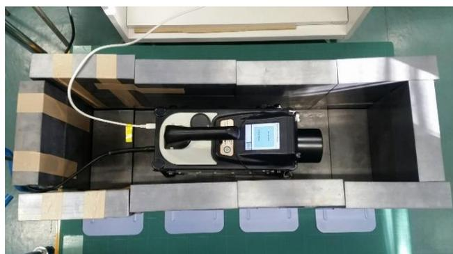
図1 測定に使用したゲルマニウム半導体検出器(Micro-Trans-SPEC, ORTEC Ltd. Co.)と厚さ5cmの遮蔽用鉛ブロック。
