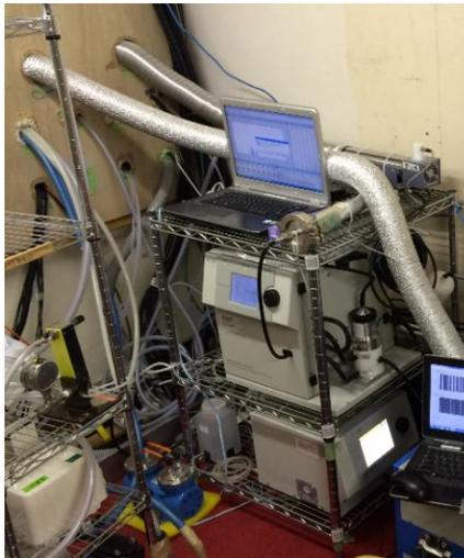
図1 走査式移動度計測装置(Nano-SMPS)による計測
