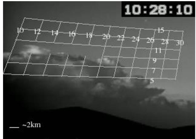
図2 北からの等方位角(縦線)と等仰角(横線)のグリッド線を写真に添付した例。カメラから対流の距離が分かるので、左下の線の長さが2kmに対応する。2015年の山頂に設置された学芸大カメラの画像利用。
