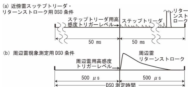
図 15 下向き雷ステップトリーダ・リターンストローク測定用 DSO、及び周辺雷現象測定用 DSO のトリガーレベルと測定時間幅
