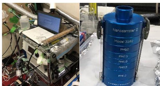
図1 観測機器 (左:Nano-SMPS, 右:ナノサンプラー)
