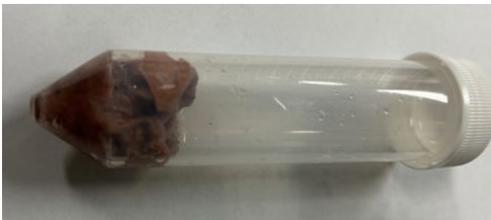
図1. 測候所屋根表層をぬぐったキムワイプ。色は屋根の塗装に由来します
