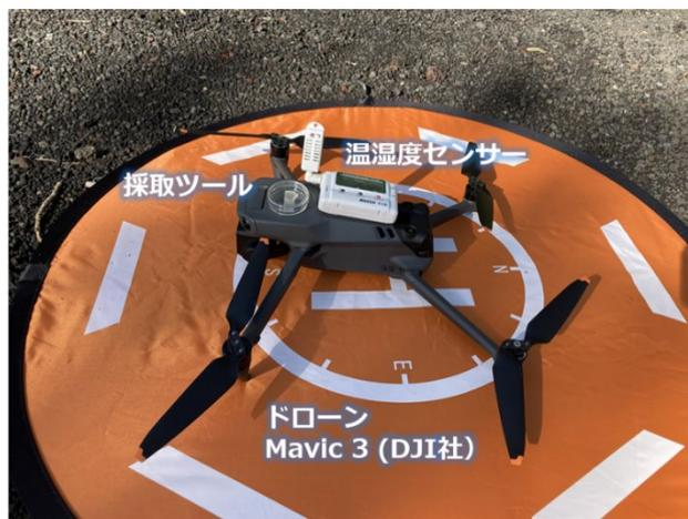
図2 雲粒採取に用いた採取ツール搭載クアッドコプター
