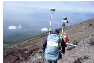
写真.3(左) 登山道でのレーザー計測状況
