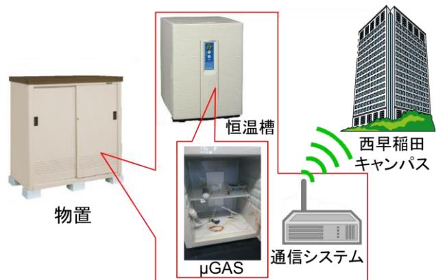
図2 火山ガス早期検知テレメーターシステム
