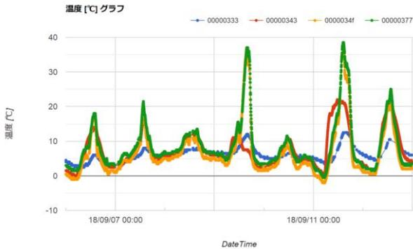
図 5 夏期 2018/9/6~9/13 の測候所内 4 カ所の温度変化
