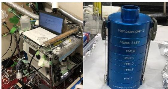
図1 観測機器 (左:Nano-SMPS, 右:ナノサンプラー)
