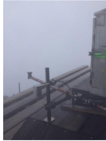
図 8 大気電場測定機器。1号庁舎屋根に設置。設置も簡便に行えることが本測定器の特徴である。
